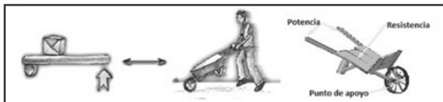
Img. 1: Ejemplo de palanca de segunda clase
