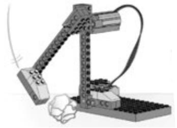
La energía se transfiere desde el motor activado por el equipo a través de la pierna. La pierna es como una palanca: el motor es el "esfuerzo" que empuja el eje (punto de apoyo). El eje gira, levantando la pierna (resistencia). Cuando la bola de papel está colocada, la energía que mueve la pierna se trasfiere a la bola.
