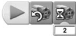
El programa "El pateador" activa el bloque activación de motor en un sentido (hacia la izquierda) y lo hace funcionar durante dos décimas de segundo. Entonces, se apaga.
