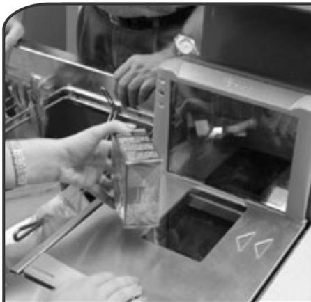
Img. 3: La máquina ScanMax utilizada para la lectura de código de barras, pesaje y desactivación de productos.
