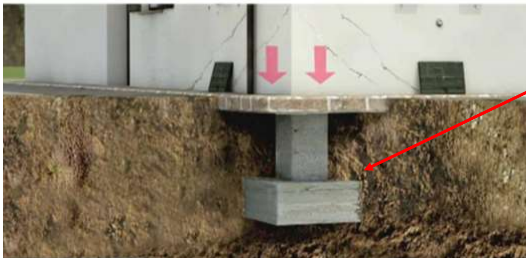
Foto: cimentación expuesta por hundimiento de suelos
