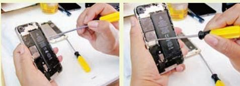
3. Luego, con un destornillador de pala retiramos la tapa para acceder al interior del celular.
