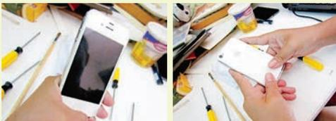
2. Con un destornillador de estrella retiramos los tornillos.
