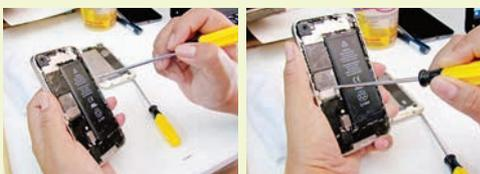
9. Cuando esté bien atornillado, procedemos a colocar la sim card, batería y la tapa.
