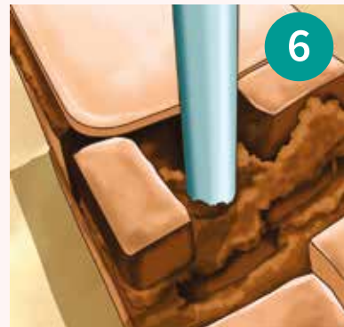
6 Introducir el tubo de la chimenea y sostenerlo con piedras y barro, dejando libre el orificio para que el humo pase.
